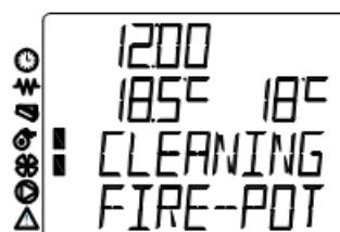
Pri isključivanju peći potrebno je pritisnuti taster 4 i zadržati ga malo dok se na ekranu ne ispiše poruka **CLEANING FINAL**. Pumpa za vodu će raditi sve dok temperatura vode u kotlu ne
