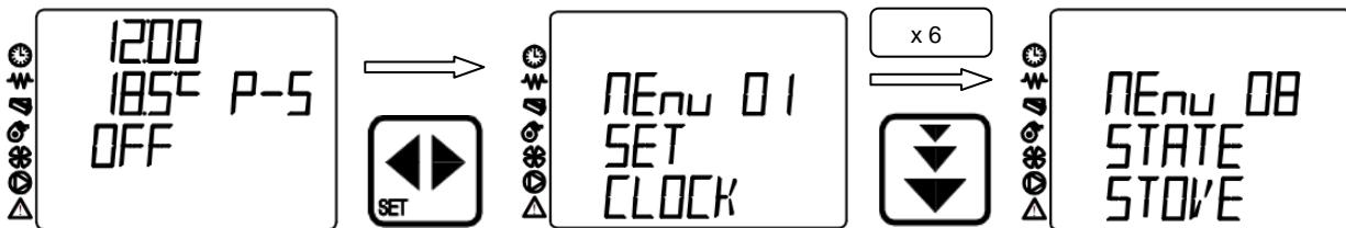
Pritiskom na taster 3 (set), ulazi se u meni za ispisivanje poruka o statusu peći. Poruke će se naizmenično menjati. Redosled ispisivanja i izgled displeja je dat na sledećoj slici.
