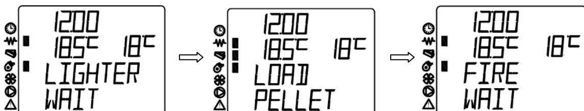
Naizmenično će se smenjivati poruke **LOAD PELLET** i **FIRE WAIT**, sve dok temperatura izduvnih gasova ne pređe 40°C, što je potrebno kako bi se detektovao plamen i kako bi peć mogla da počne sa radom. Maksimalno vreme za koje je potrebno da peć dostigne 40°C je 25 minuta. Na ekranu će biti ispisana poruka
