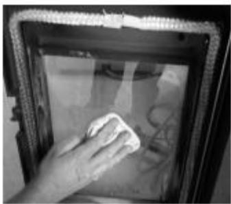
Staklo čistiti isključivo kada je peć ohlađena. Staklo čistiti suvom krpom, ako ima tragova gareži ili drugih tragova na staklu može se očistiti i sa vlažnom krpom, nakon čega opet prebrisati suvom krpom saklo.
