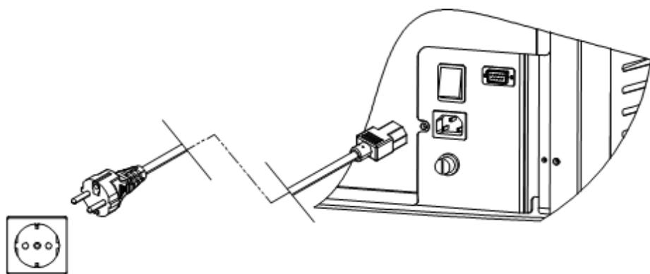
Slika 5. Povezivanje peći na izvor električne energije
