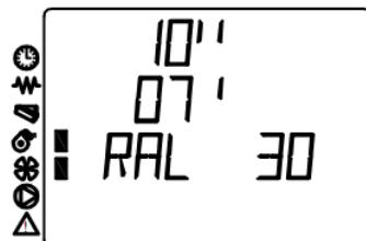
Pritiskom na taster 6 i zadržavanjem tastera pojaviće se sledeći izgled ekrana. Ovde se mogu videti podaci o preostalom vremenu do sledećeg režima rada peći. Jednostavnim pomerajem prsta sa tastera, ekran će se vratiti na osnovni meni.
