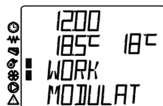
Podešavanje temperature vode u kotlu se vrši pritiskom na taster 1. Peć će grejati do te temperature i potom istu održavati. Zadavanje se vrši tako što se taster 1 pritisne kratko i potom pritiskanjem na taster 1 ili 2 se povećava ili smanjuje zadata temperatura vode. Ova radnja će biti propraćena ispisivanjem poruke **SET TEMP WATER**. Temperaturu je moguće menjati u intervalu od 20 do 80°C.
