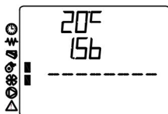
Pritiskom na taster 5 i zadržavanjem tastera pojaviće se sledeći izgled ekrana. Ova opcija je namenjena za peći za etažno grejanje, tako da kod obične peći nema nikakvu namenu. Ovde se mogu videti podaci o zadatoj temperaturi vode u kotlu, kao i pritisak u kotlu. Jednostavnim pomerajem prsta sa tastera, ekran će se vratiti na osnovni meni.
