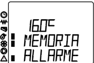
Poništiti alarm, pritiskom na taster 4, sačekati da se peć ohladi. Potom, postupiti prema upustvu opisanom u odeljku **8.7 POČETNO UBACIVANJE PELETA** i startovati peć.
