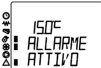
Greška se može javiti usled neispravnosti sonde koja meri temperaturu izduvnih gasova, usled niske temperature izduvnih gasova, nedovoljne količine peleta koja je potrebna za paljenje ili usled neispravnosti upaljača.
