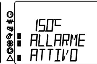
Greška se može javiti usled zaglavljivanja ventilatora, kao i usled neispravnosti kontakta koji napajaju ventilator el. energijom ili usled prekida kablova koji mere broj obrtaja ventilatora. Ako se javi ova greška obavezno kontaktirati servis. Neispravnost ventilatora može se uočiti i pritiskom na
