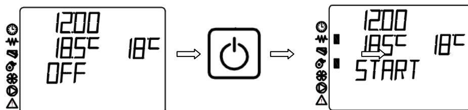
Prilikom starta će se uključiti indikatori koji prikazuju šta je od elemenata peći trenutno uključeno. Ventilator izduvnih gasova će raditi sve dok je peć uključena i još neko vreme prilikom isključivanja peći.
