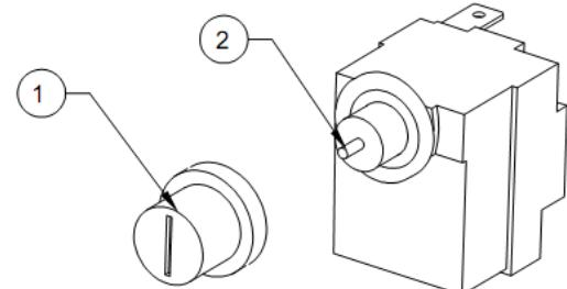
**Greška usled neispravnosti sigurnosnog presostata.** Sigurnosni presostat služi za proveru potpritiska u odvodu dima. Ako je podpritisak nedovoljan peć će prestati sa radom ili neće moći da se upali. Prilikom neispravnosti sigurnosnog presostata na displeju će se pojaviti poruka kao što je prikazano na sledećoj slici (**AL 8 FAILURE DEPRESS**) i naizmenično će se menjati sa porukom koja prijavljuje grešku u radu (**ALLARME ATTIVO**).
