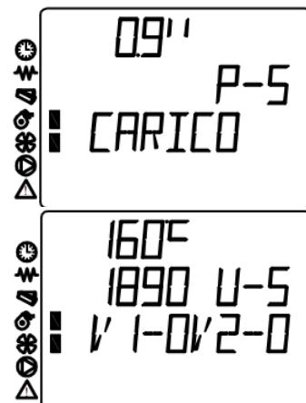
Pritiskom na taster 2 i zadržavanjem tastera pojaviće se sledeći izgled ekrana. Ovde se mogu videti podaci o temperaturi izduvnih gasova, režimu rada peći, brzinama ventilatora za kanalsko odvođenje toplote (opcije). Jednostavnim pomerajem prsta sa tastera, ekran će se vratiti na osnovni meni.
