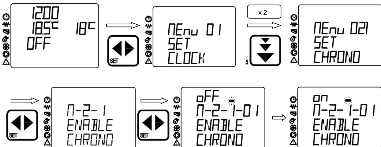
Nakon uključenja tajmera na displeju će se uključiti indikatori koji pokazuju koja je vrsta programiranja aktivirana (dnevno, nedeljno, vikend) i indikator pored simbola za sat koji označava da je tajmer uključen. Izgled ekrana i oznake indikatora date su na sledećoj slici.
