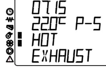
**Previsoka temperatura izduvnih gasova.** Ako se temperatura izduvnih gasova ne spušta i prilikom ispisivanja poruke **HOT EXHAUST**, peć će nastaviti sa radom u minimalnom režimu sve dok je temperatura manja od 280 °C. Ako temperatura pređe 280 °C peć će javiti grešku **AL3 SMOKE HOT**.
