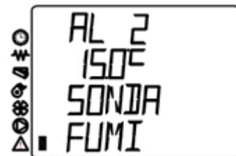
Takođe, provera sonde koja meri temperaturu izduvnih gasova se vrši na sledeći način. Pritisnuti taster 2 i zadržati ga dok se ne pojavi sledeći prikaz ekrana. Broj 373°C označava da je sonda izduvnih gasova neispravna ili nije dobro priključena u konektor. Za ovaj problem obavezno je pozvati ovlašćenog servisera.
